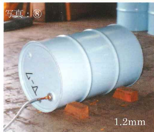
写真：⑧ 胴板：1.2mm 破壊：670mmHg 天地板：1.2mm で破壊せず 空缶重量：21.85kg
